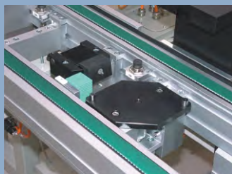
■ Poste de rotation Draaistation
