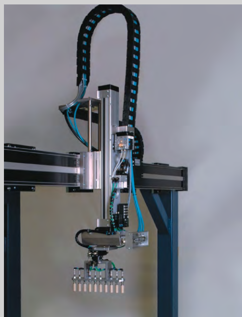
■ X-Z unité de pick & place X-Z pick & place eenheid
